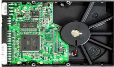
Mạch điều khiển nằm phía sau ổ cứng
