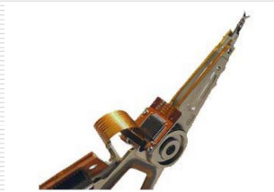
Cần mang đầu từ và IC khuếch đại tín hiệu đầu từ
