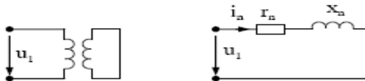
Hình 6.3 Sơ đồ lúc mba bị ngắn mạch
