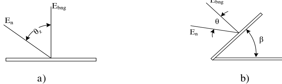
Hình 1.2.8. Các thành phần bức xạ lên bề mặt ngang (a) và nghiêng (b)
