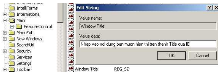
Hình 2.14: Nhấp đúp lên string Window Title và nhập vào nội dung hiển thị
