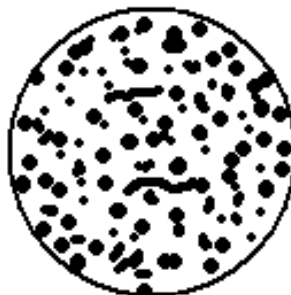
Hình 2.53. Tổ chức tế vi của gang trắng a. trước cùng tinh và sau cùng tinh b. cùng tinh c.
