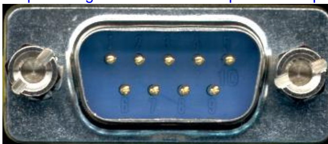
Hình 4.2 – Sơ đồ chân cổng nối tiếp
