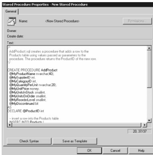
Hình 4.7: Sử dụng Bộ quản lý doanh nghiệp (Enterprise Manager) để định nghĩa một thủ tục
