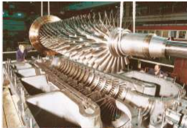
Hình H-16C- Hình ảnh minh họa cấu tạo bên trong máy nén hướng trục
