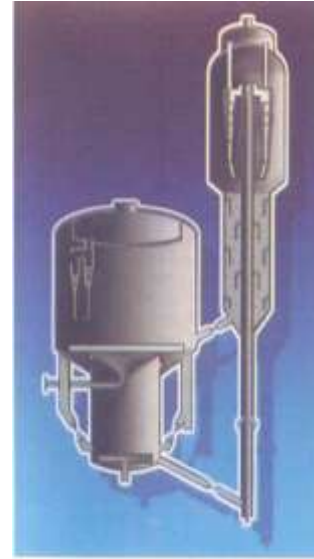
Hình H-1.15-Thiết bị phản ứng với tái sinh xúc tác hai bậc (công nghệ UOP)
