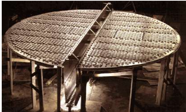
Hình H-5.13- Hình ảnh kết cấu tổng thể của đĩa van lắp đặt trong tháp chưng cất
