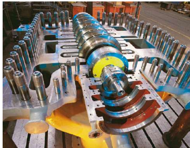
Hình H-3.5B- Minh họa cấu tạo bên trong máy nén ly tâm
