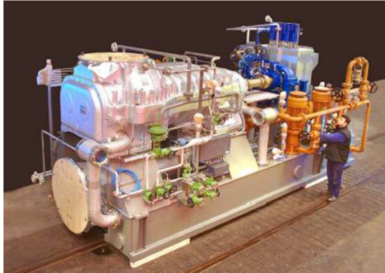
Hình H-3.4-Cụm máy nén kiểu trục vít lắp đặt hoàn chỉnh
