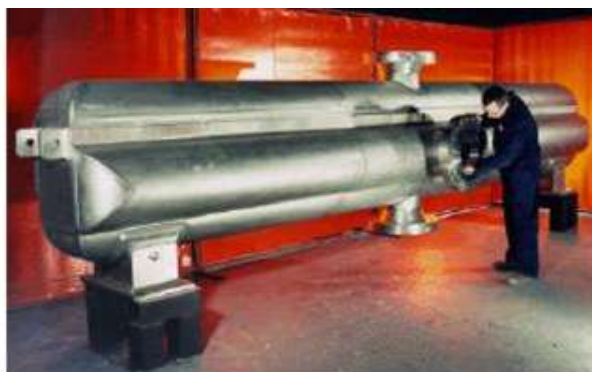
HÌNH H-2.36 Hình dạng thiết bị trao đổi nhiệt kiểu bo mạch in
