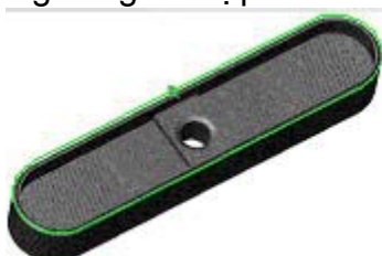
Tạo hình tiết theo đường dẫn lấy đường cong đa hợp làm đường dẫn.
