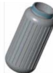
Hình 6.10. Hình khối dẫn (màu xanh) tạo đường ren trên cổ chai
