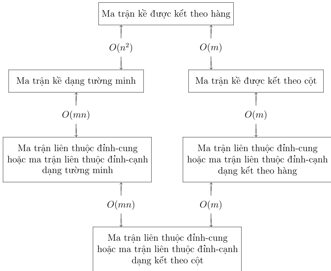
Hình 1.10: Mối liên hệ và độ phức tạp tính toán khi chuyển đổi giữa các biểu diễn khác nhau trong đồ thị.
