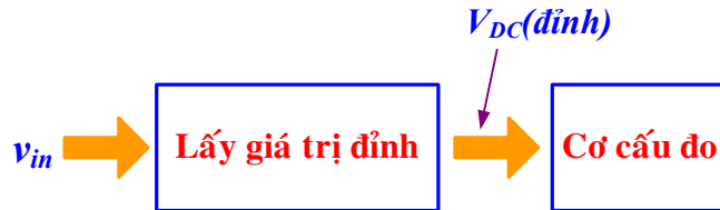
Hình 3.22. Đo điện áp AC sử dụng phương pháp trị giá trị đỉnh
