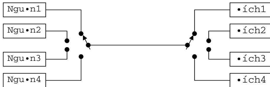
Hình: Mô hình dùng mạch đa hợp, mạch giải đa hợp truyền dữ liệu.
