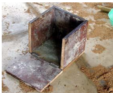
Hình 5.26. Khung gỗ để đặt túi nylon làm bịch vuông
