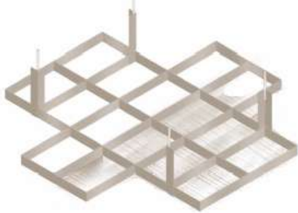
Hình H-5.30A. Nắp giữ đệm kết hợp với bộ phận phân phối
