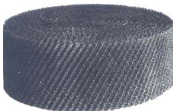
Hình H-5.22B. Dạng đệm tấm lưới
