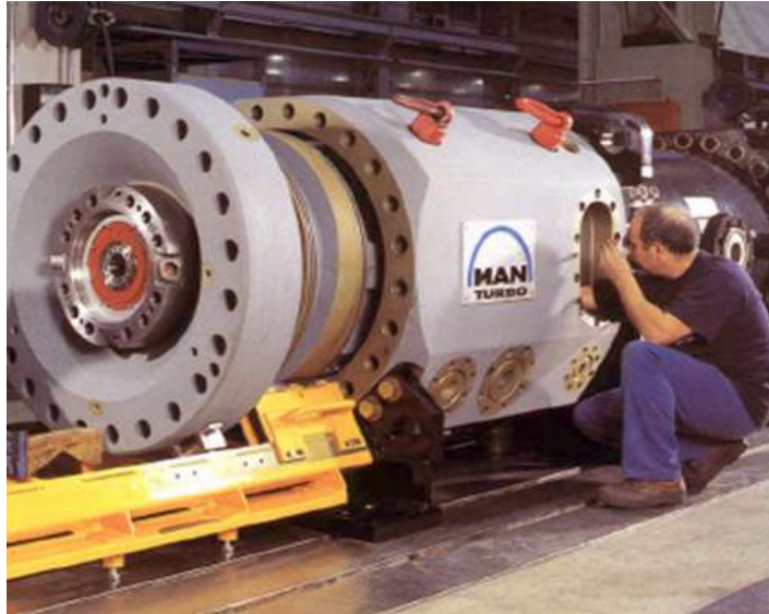
Hình H-3.6-Hình ảnh máy nén ly tâm lắp đặt hoàn chỉnh
