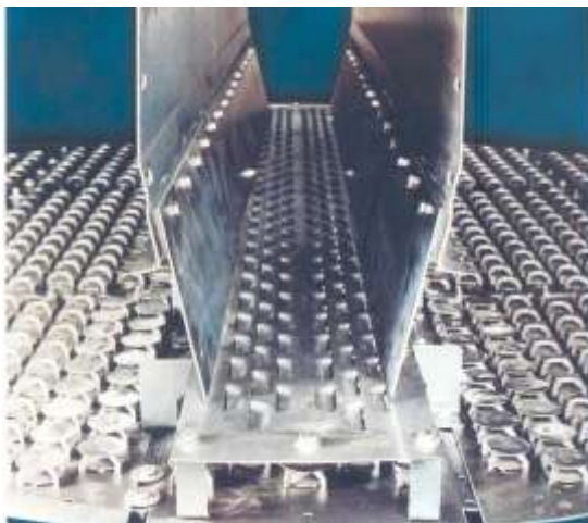
Hình H-5.18. Sơ đồ bố trí đĩa chưng phân dưới ống chảy truyền
