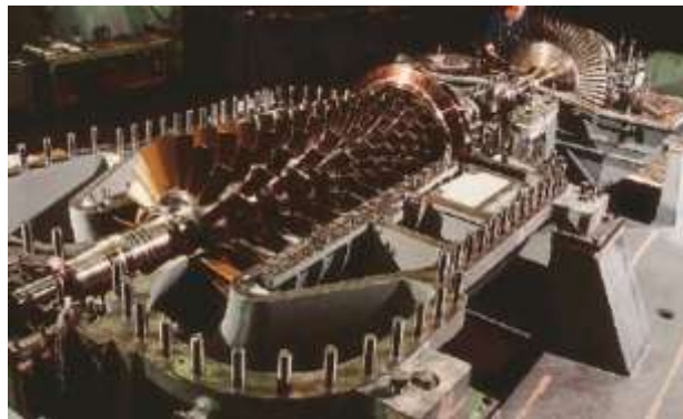
Hình H-3.12B- Hình ảnh cấu tạo bên trong máy nén hướng trục
