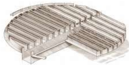
Hình H-5.28B. Hệ thống thu chất lỏng dạng máng
