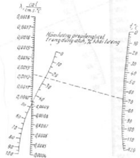
Hình 1.47. Toán đồ để xác định hệ số dẫn nhiệt của dung dịch propilenglicol-nước [49.168]
