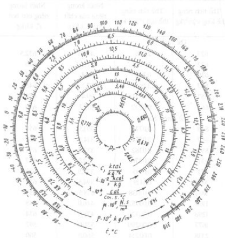
Hình 1.83. Toán đồ để xác định tính chất lý hóa của hydro ở áp suất khí quyển [49.252]
