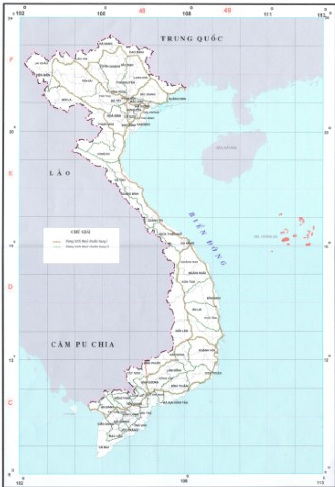
Hình 5.11. Sơ đồ lưới độ cao quốc gia hạng I và hạng II của Việt Nam
