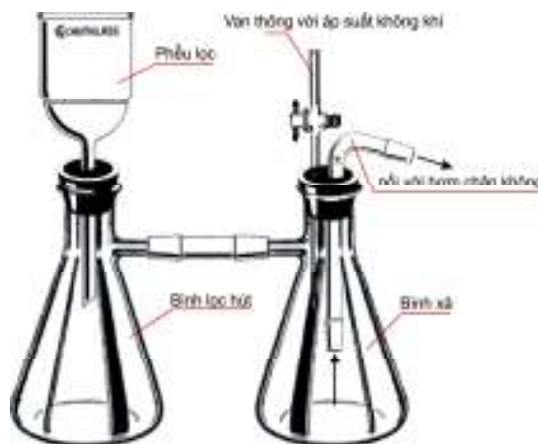
Hình 2. 4. Hệ thống lọc dưới áp suất thấp dùng phễu xóp, hoặc phễu Bucne
