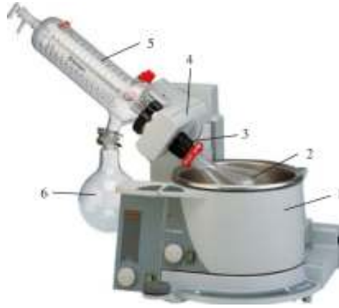
Hình 1. 35. Mô tả máy chưng cất-quay hiện đại (1: bếp cách thủy, 2: bình phản ứng, 3: bộ phận quay, 4: mô tơ quay, 5: ống sinh hàn nước, 6: bình hứng)
