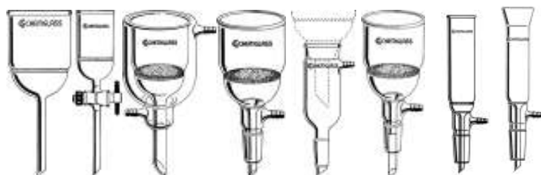
Các loại phễu lọc xóp ở áp suất thường và áp suất thấp
