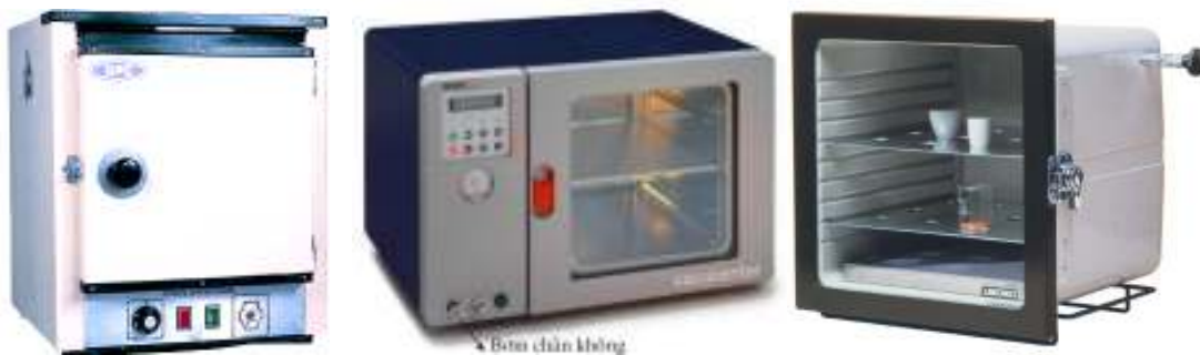
Hình 2. 7. Các loại Tủ sấy làm khô ở áp suất thường hoặc trong chân không
