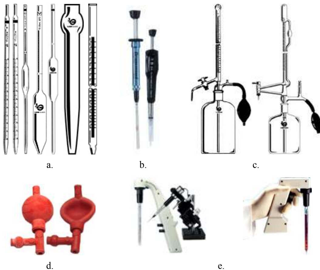
Hình 1. 12. Một số loại pipet (a. thông thường, b. pipet microlit, c. pipet lấy \text{NH}_3 , d. bóp cao su, e. pipet hiện đại)
