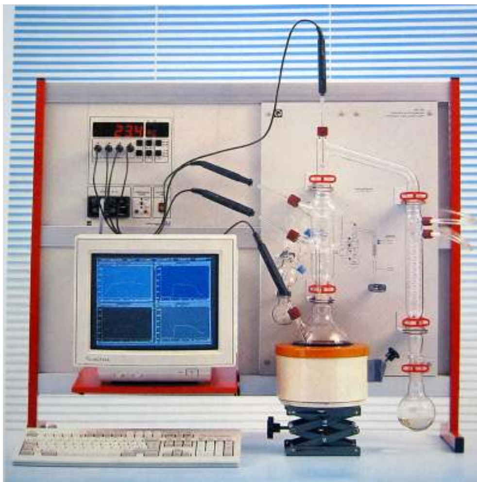
Hình 3. 8. Hệ thống chưng cất phân đoạn với 4 điểm xác định nhiệt độ
