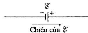
Hình 20-19. Chiều của suất điện động của một bộ pin đi từ cực âm tới cực dương của nó.
