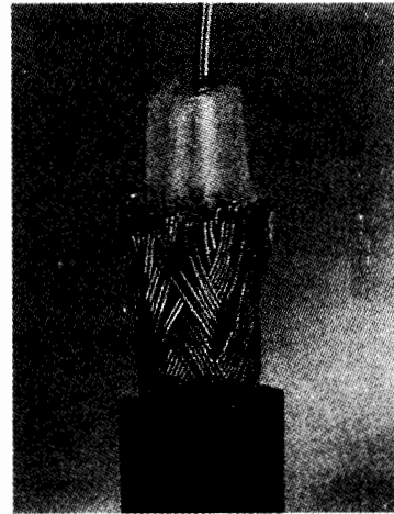
Hình 19-5. Một dây cáp đồng trục là một tụ điện trụ. Một dây dẫn đặt bên trong chạy xuyên qua giữa một vật liệu cách điện bằng chất dẻo. Vật liệu này được bao quanh bởi một vỏ bằng dây dẫn bện lại. Dây bện lại được bọc ngoài bằng lớp vỏ cao su cách điện.
