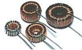
Cuộn dây hình nôi: loại này có ưu điểm như toroid ở chỗ lõi có khuynh hướng ngăn chặn từ thông vượt ra ngoài kết cấu vật lý. Độ tự cảm của cuộn dây lõi nôi được tăng lên một cách đáng kể với một kích thước nhỏ. Nhược điểm chính là việc điều chỉnh rất khó khăn và phải chuyển đổi số vòng dây nhờ các van tại các điểm khác nhau của cuộn dây.
