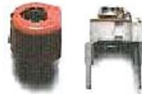
Trị số của tụ vi chỉnh thường nhỏ từ 0 đến vài chục pF. Loại tụ này thường được mắc kết hợp với tụ xoay và dùng chủ yếu để cân chỉnh mạch.
