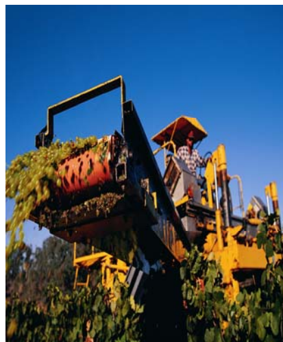
Hình 1.3. Thu hoạch nho bằng máy
