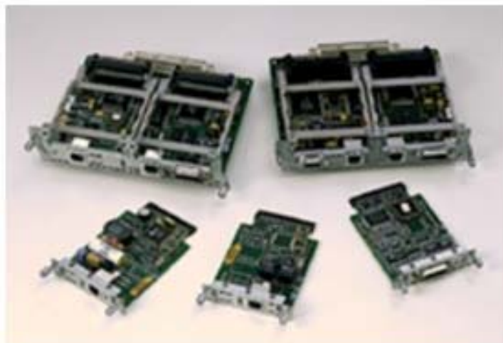
Hình 3-12: Module Ethernet có khe cắm WAN
