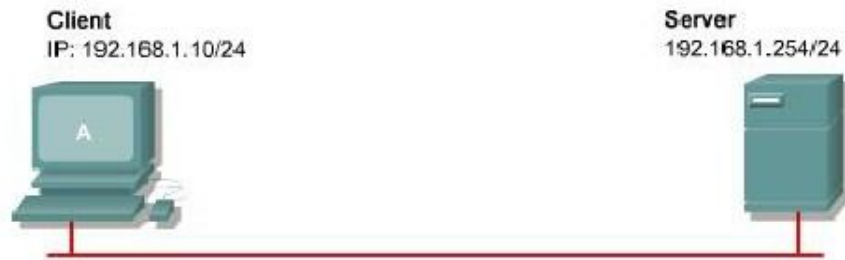
Hình 1.2.1.c. Hệ điều hành trên DHCP client sẽ dùng những thông tin nhận được trong gói trả lời server để cấu hình IP cho client đó.
