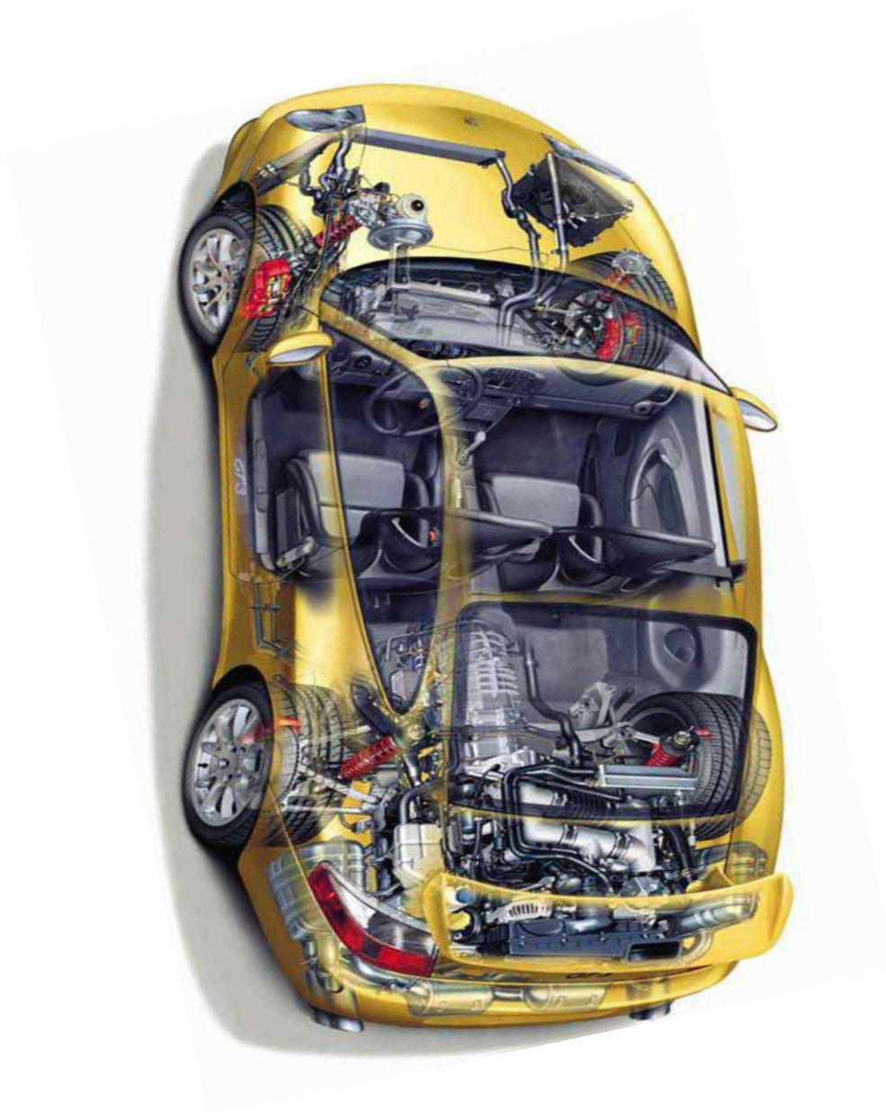
Hình 2. Oto du lịch Madaz, động cơ đặt ngang phía sau.
