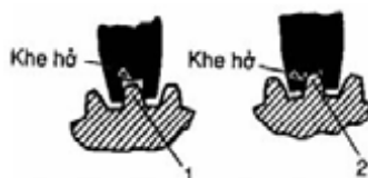
Hình 38. Kiểm tra mòn răng bằng dưỡng đo răng.
