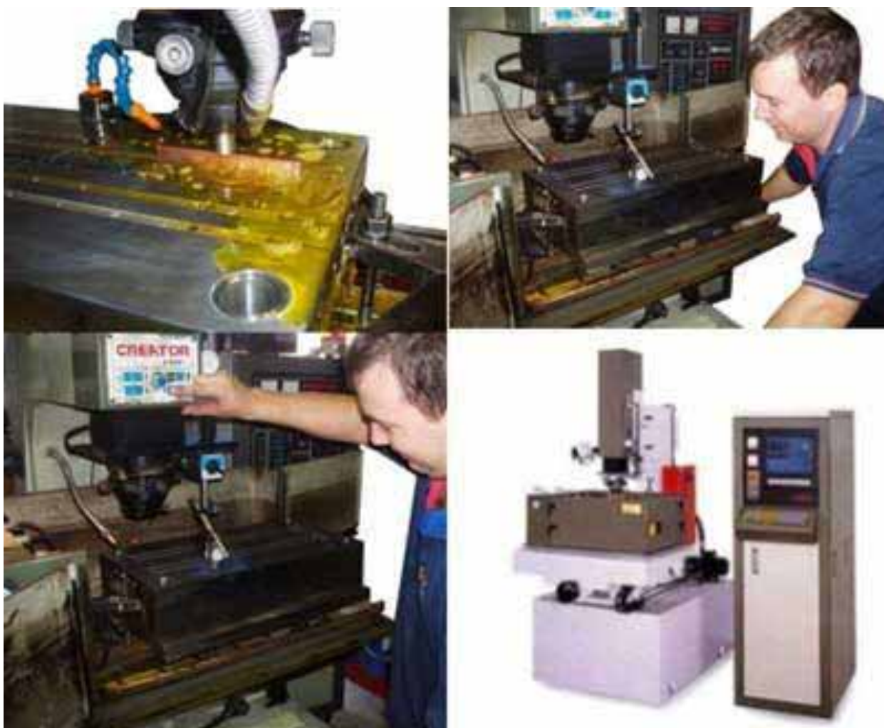
Hình 37. Gia công kim loại bằng tia lửa điện.
