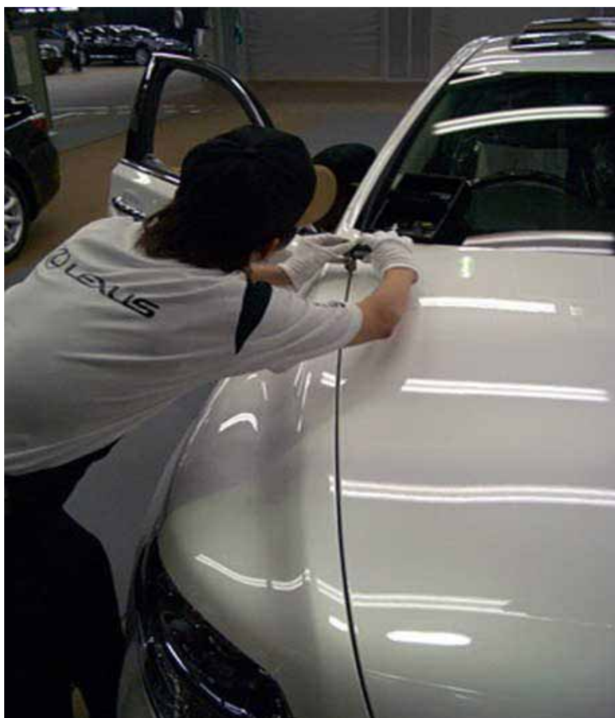
Hình 41. Kiểm tra khoảng cách giữa nắp ca-pô và cánh trước của xe Lexus, sử dụng máy định cỡ digital.
