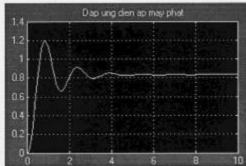
Hình 7.34: Đáp ứng điện áp phát từ kết quả mô phỏng
