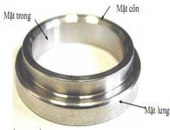
Hình 2.7- Cấu tạo của Đế xupáp
