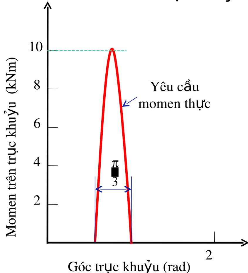
Máy đập được dẫn động (qua hộp giảm tốc) bởi motor có số vòng quay  $n = 1200 \text{ rpm}$ . Bỏ qua ảnh hưởng của quán tính. Hãy xác định **công suất cần thiết của motor** để đảm bảo momen lớn nhất của trục khuỷu? **Giải**
