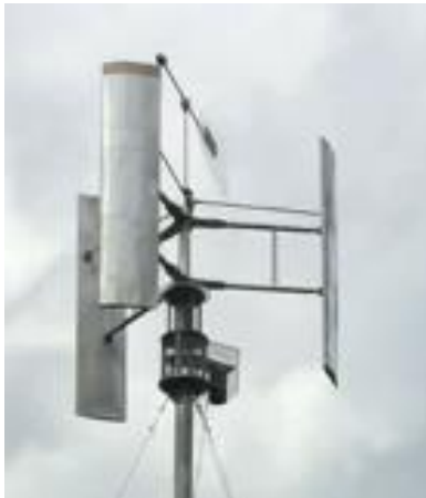
Hình 12. Tuabin gió tự điều chỉnh cánh đã chế tạo
