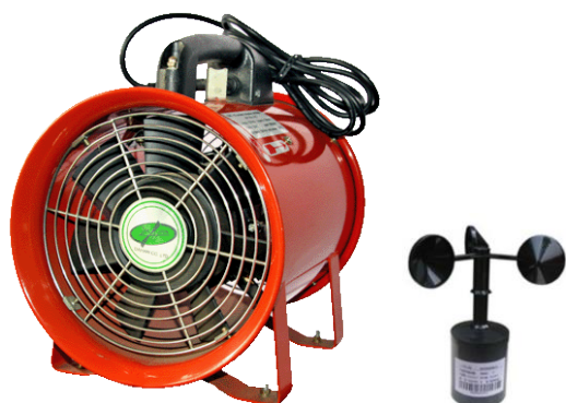
Hình 13. Thiết bị tạo gió nhân tạo và cảm biến đo gió YJFS -H4A5
