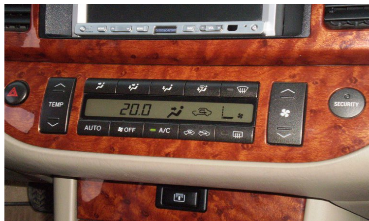
Hình 1.2: Ví dụ bảng điều khiển điều hòa tự động trên ô tô Toyota Camry
