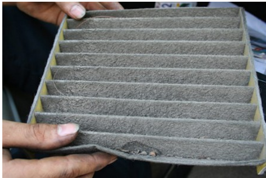
Hình 3.2. Lọc gió điều hòa quá bẩn
