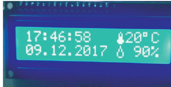
Hình 4. Màn hình LCD hiển thị thông số nhiệt độ, độ ẩm, và thời gian
