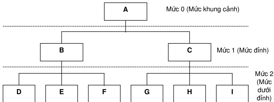
**Hình 3.4.** Cấu trúc một biểu đồ phân cấp chức năng**b. Phân mức để vẽ nhiều biểu đồ luồng dữ liệu:**
