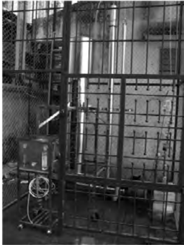
Hình 4.1. a. Mô hình pilot công suất 15 m 3 /ngđ; b. Lắp ráp thiết bị lọc công suất 100 m 3 /ngđ
