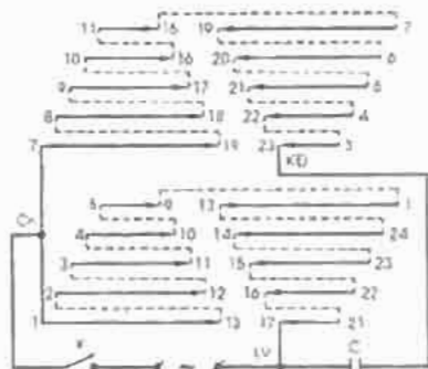
Hình 8-49. Cấu tạo ống dây và sơ đồ đấu dây trong động cơ một pha tự điện. 2 cực, 24 rãnh, 4 tổ bội năm kiểu mẹ con.
