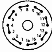
Hình 8-18. Cấu tạo ống dây và sơ đồ đấu dây trong quạt trần vòng chập, 16 cực, 8 tổ bội đơn.
