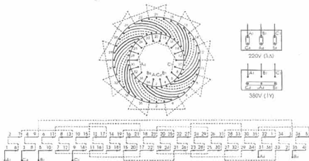
Hình 8-62. Cấu tạo ống dây và sơ đồ đấu dây kiểu 1Δ và 1Y cho động cơ ba pha, 6 cực, 36 rãnh, 18 tổ bố trí
