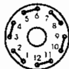
Hình 8-17. Cấu tạo ống dây và sơ đồ đấu dây trong quạt trần vòng chập. 12 cực, 6 tổ bố đơn.
