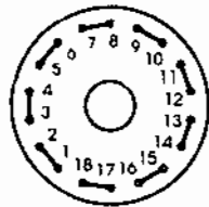
Hình 8-19. Cấu tạo ống dây và sơ đồ đấu dây trong quạt trần vòng chập, 18 cực, 9 tổ bội đơn.
