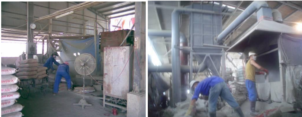
Hình 6: Nạp liệu xi măng thủ công không có hút bụi và có hút bụi xyclon
