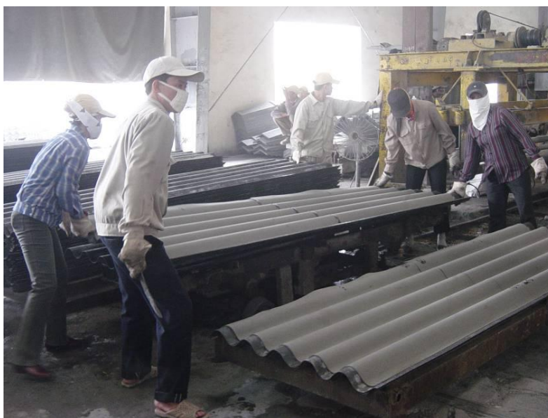
Hình 8: Thành hình và vận chuyển thủ công
