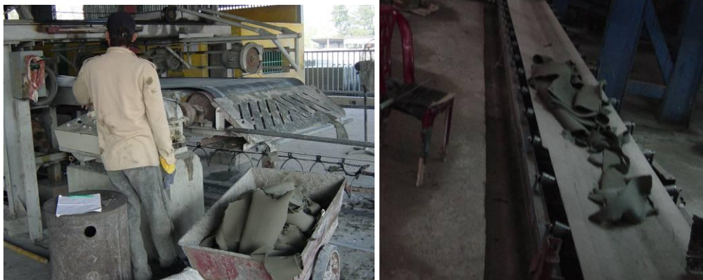
Hình 7: Vận chuyển vật liệu ẩm thủ công và bằng băng tải
