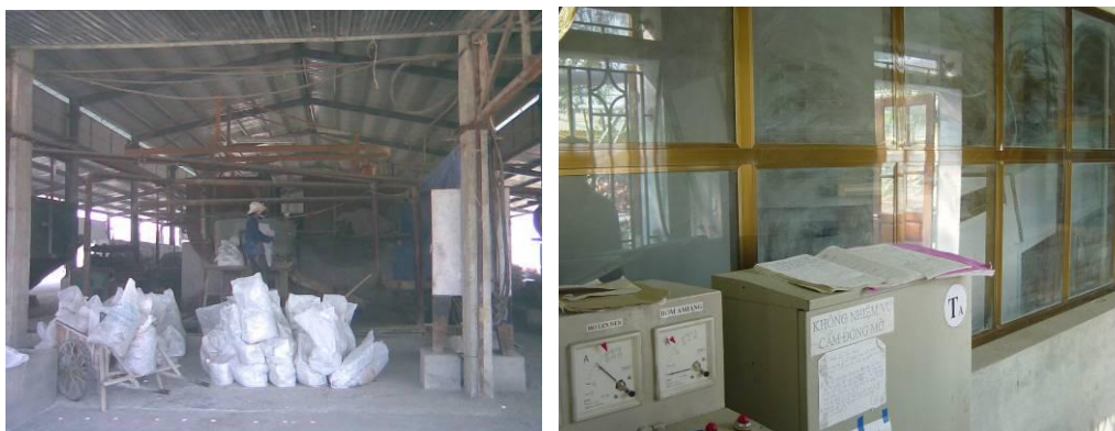
Hình 5: Tháo bao amiăng thủ công và tháo bao tự động trong buồng kín
