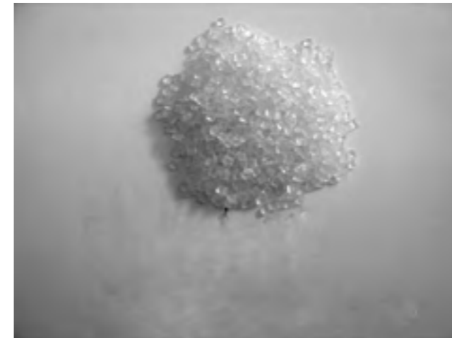
Hình 1. Hạt nhựa trơ TRW18 sau khi ngâm trong dung dịch HCl 0.1M
