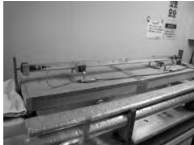
Hình 2. Lắp đặt hệ đo thử hai lúc 24 giờ sau khi đổ
