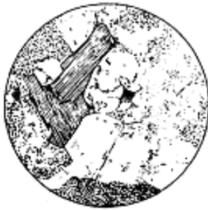
Hình 1.10 Mẫu lát mỏng của đá granit chứa fenspat, thạch anh và biotit
