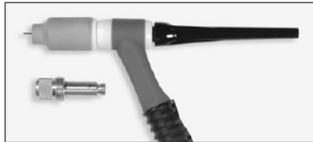
Hình 8 : đầu hàn sử dụng ống hội tụ để giảm sự cuộn xoáy của dòng khí bảo vệ
