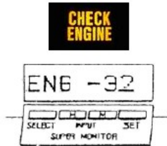
Hình III – 3.1.2 : Hệ thống tự chuẩn đoán bằng máy quét
