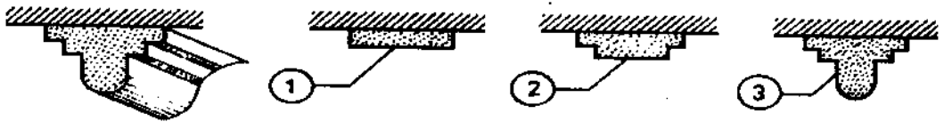
Hình II.5: Trình tự trát chỉ Trát chỉ theo thứ tự 1, 2, 3.
