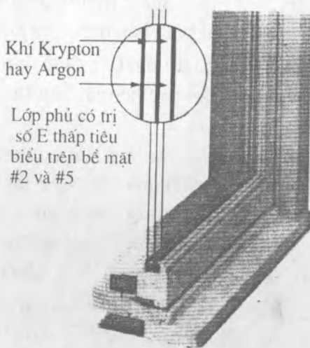
Hình II.1: Cấu kiện kính chắn nhiệt ghép ba lớp kính (Cửa và cửa sổ của Marvin)
