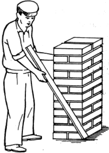
Kiểm tra mặt phẳng trụ
