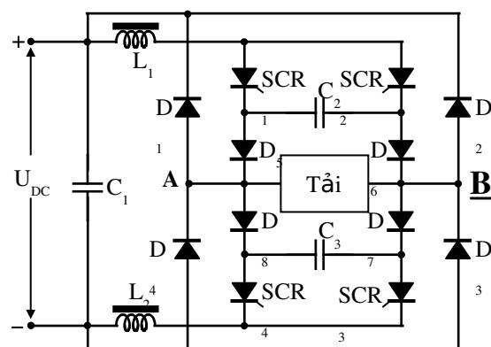
Mạch nghịch lưu áp một pha dùng cầu SCR từ SCR<sub>1</sub> đến SCR<sub>4</sub> chia làm 2 cặp SCR<sub>1</sub> - SCR<sub>3</sub> và SCR<sub>2</sub> - SCR<sub>4</sub> được điều khiển lùi phiên. Tụ C<sub>1</sub> là lọc thành phần xoay chiều và là tụ nạp điện áp phản kháng đưa trả về nguồn.
