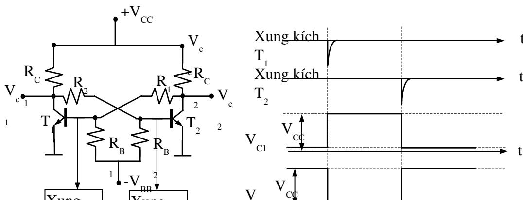
Mạch có cấu tạo gồm 2 phần đối xứng giống nhau nhưng vẫn có sự bất cân xứng dù rất nhỏ, nên khi vừa mới đóng điện 1 trong 2 Transistor sẽ có linh kiện dẫn mạnh hơn linh kiện kia chút ít.
