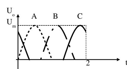
$t = \frac{1}{6} u_C$  và  $u_A$  lớn nhất ,nên  $D_3$  và  $D_1$  cùng dẫn ,dòng điện đi từ pha C và pha A     $D_3 \& D_1 \quad R_L \quad N.$
