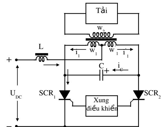
Biến áp dùng trong mạch này là loại biến áp cách ly ,cuộn sơ có điểm giữa gồm 2 cuộn giống nhau về vòng dây ,đuờng kính .
