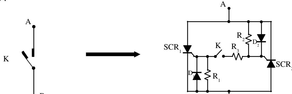
Để khắc phục nhược điểm này người ta thay vào đó là **biến công tắc dùng linh kiện điện tử** công suất hay còn gọi là **mạch công tắc không tiếp điểm**. Ưu điểm của mạch này là dùng linh kiện bán dẫn đóng cắt mạch điện nên không tạo ra hồ quang điện, tải hoạt động ổn định.
