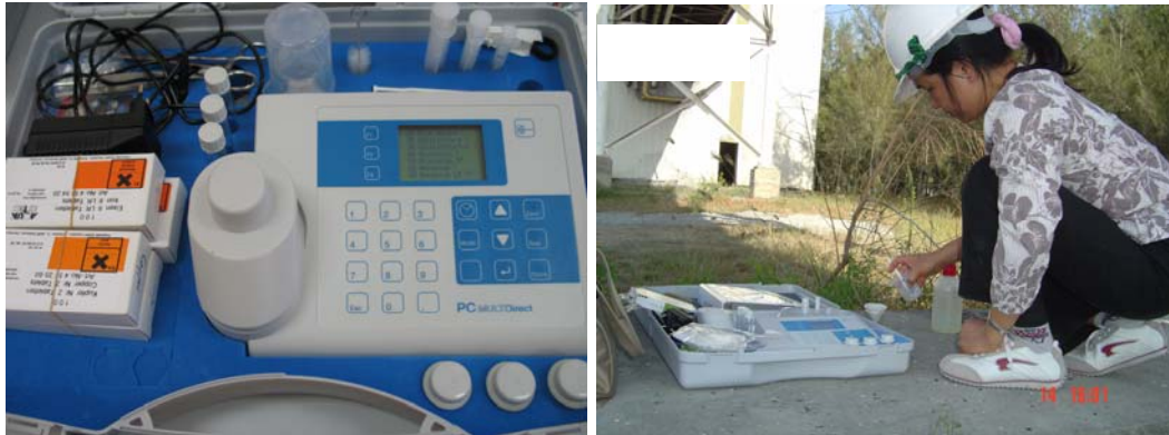
Hình 10: Phân tích và hàm lượng ion Cl - trên bề mặt kết cấu tại Nhà máy xi măng Hòn Chông (Hà Tiên)
