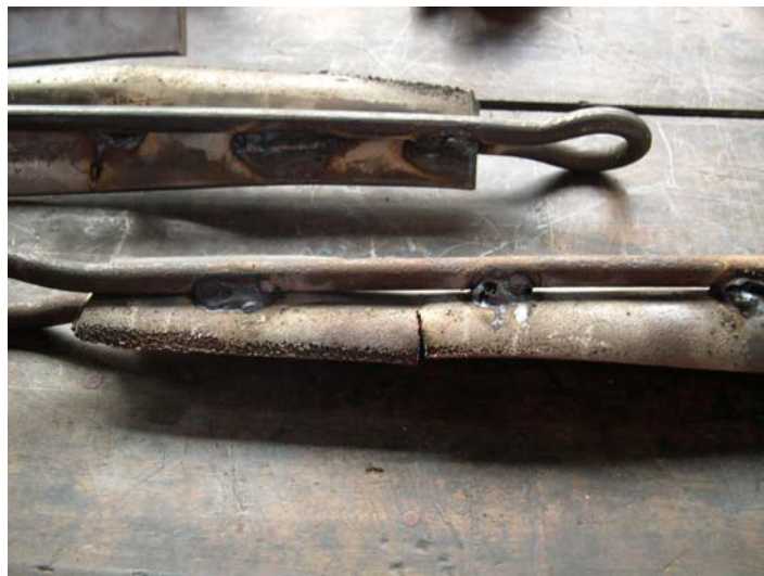
Hình 11: Vết nứt trên cánh tuốcbin của nhà máy nhiệt điện
