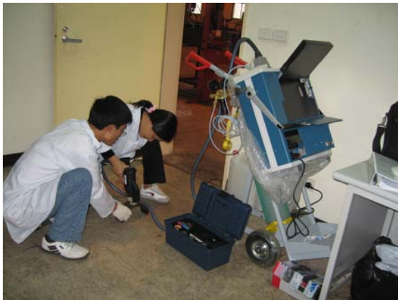
Hình 7 :Thiết bị phân tích quang phổ di động - Phân tích thành phần hóa học kim loại và hợp kim tại phòng thí nghiệm và tại hiện trường (ảnh dưới - tại Nhà máy điện Phả Lại)
