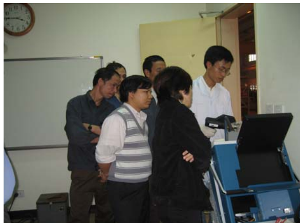
Hình 7 :Thiết bị phân tích quang phổ di động - Phân tích thành phần hóa học kim loại và hợp kim tại phòng thí nghiệm và tại hiện trường (ảnh dưới - tại Nhà máy điện Phả Lại)
