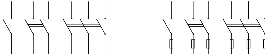
Hình 2.8: Ký hiệu cầu dao có cầu chì và không có cầu chì
