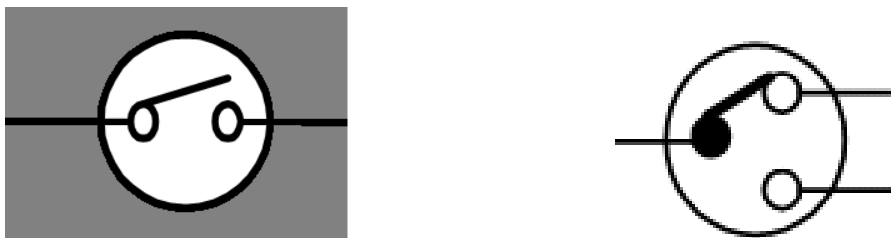
Hình 2.1: Công tắc 2 chấu và 3 chấu
