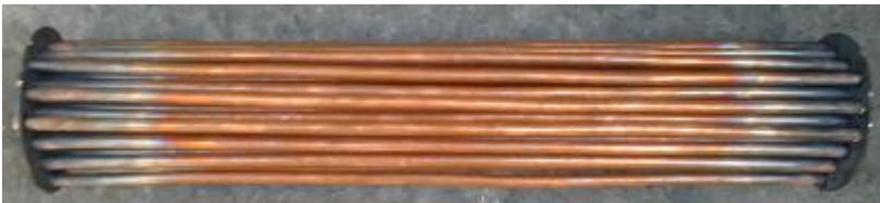
Hình 4.10. Cấu tạo dàn ống trao đổi nhiệt của bình ngưng
