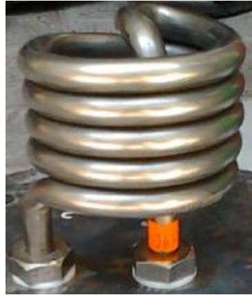
Hình 4.6. Cấu tạo điện trở
