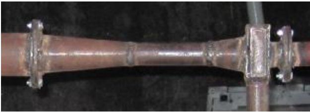
Hình 4.5. Cấu tạo Ejector.
