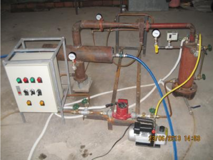
Hình 4.18. Mô hình máy lạnh ejector
