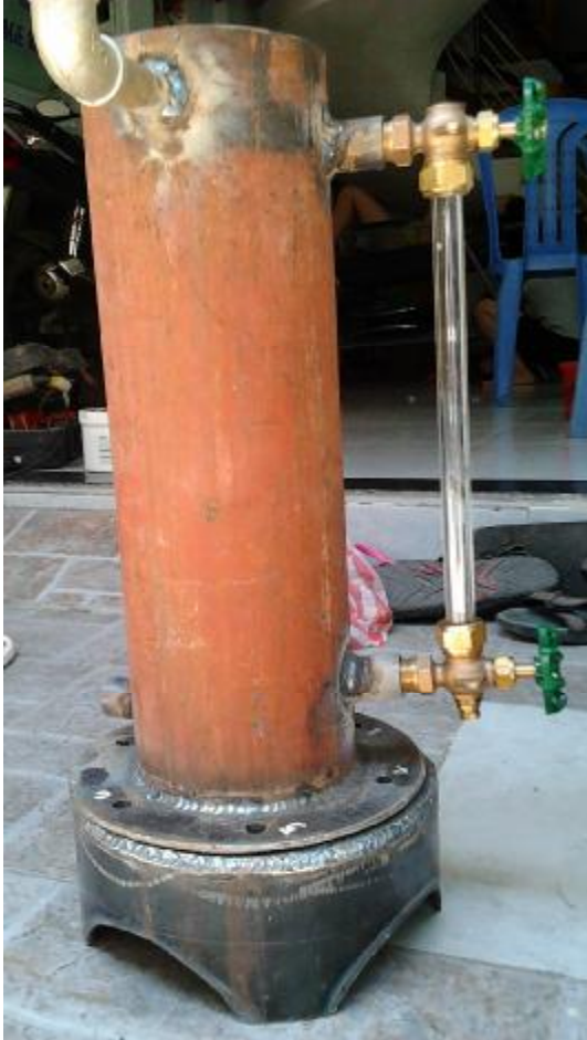
Hình 4.9. Hình ảnh thực cấu tạo Lò hơi
