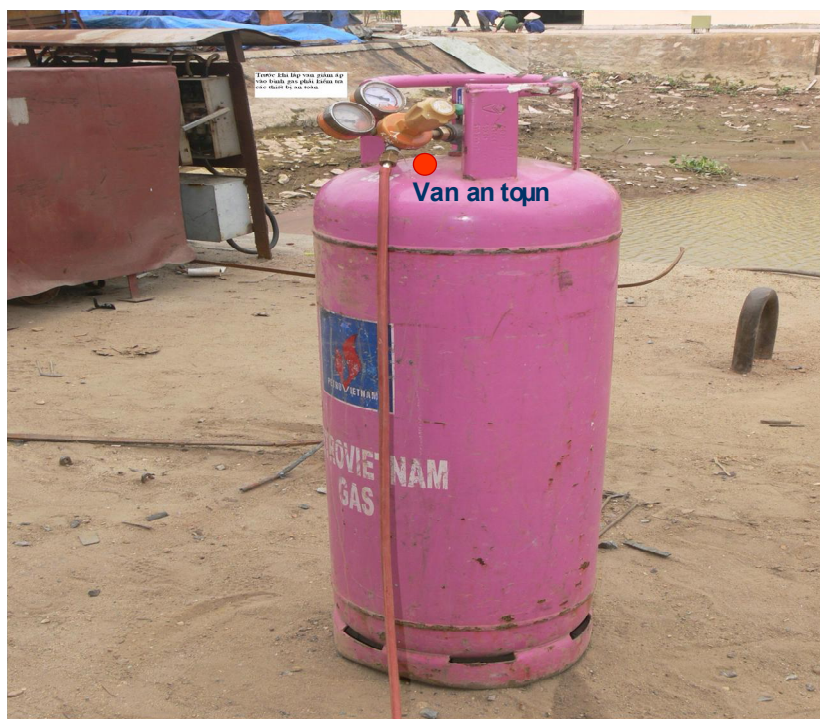
Hình 3.3. Thiết bị chịu áp lực (Bình khí ga)
