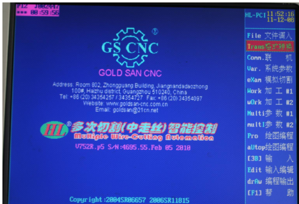
Hình 2.4: Màn hình làm việc của máy cắt dây GS5060T60H50
