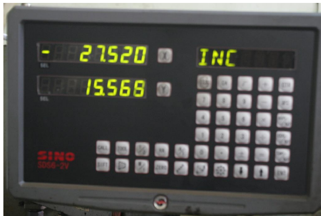
Hình 3.21: Bảng điều khiển thước quang học.
