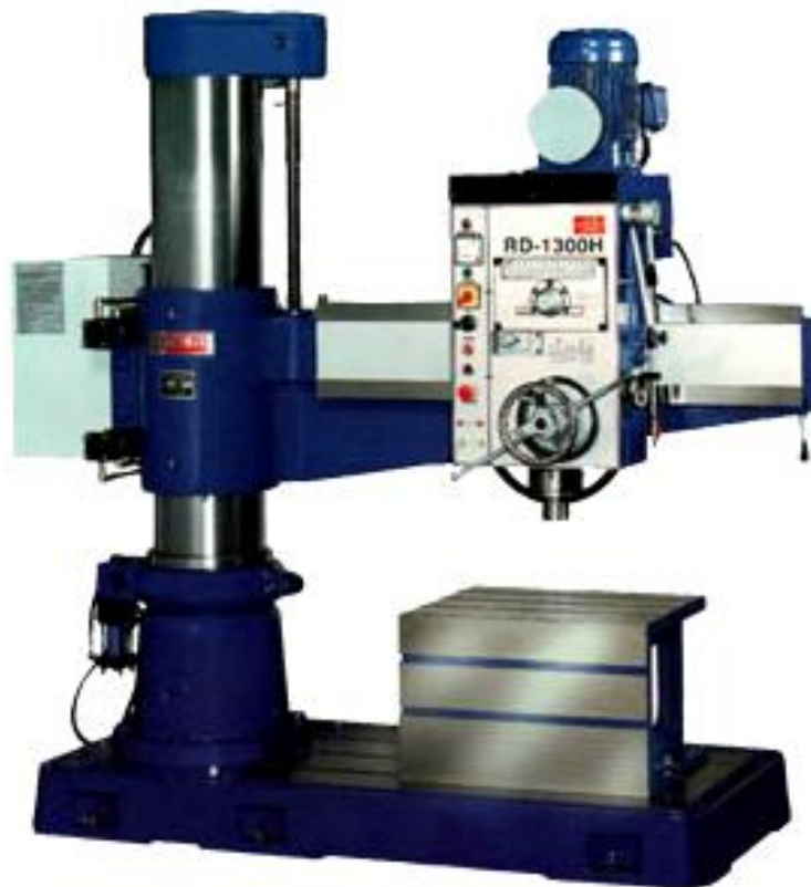
Hình 5.11. Máy khoan cần.
