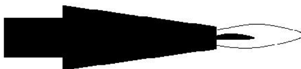
Hình 2.4. Ngọn lửa hàn ô-xy hóa.
