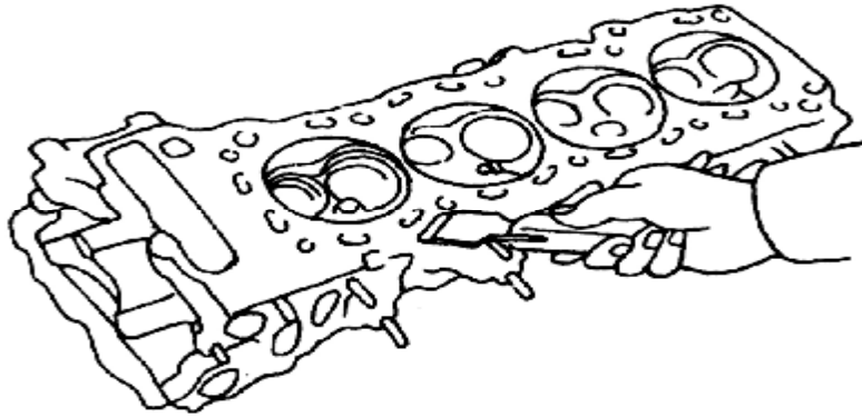
Hình 3.4 Làm sạch mảnh vụn của đệm, keo còn dính trên bề mặt.
