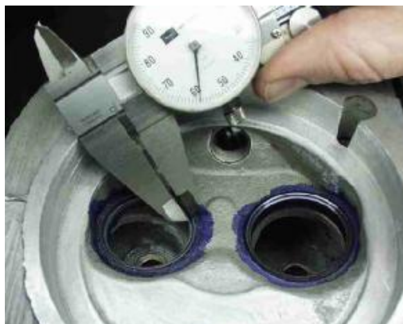
Hình 3.23: Kiểm tra ổ đặt bằng thước cặp
